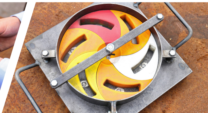
Formy s kovovým pláštěm dnes v Průmyslové keramice stále častěji doplňují jádra vytištěná z materiálu PLA
