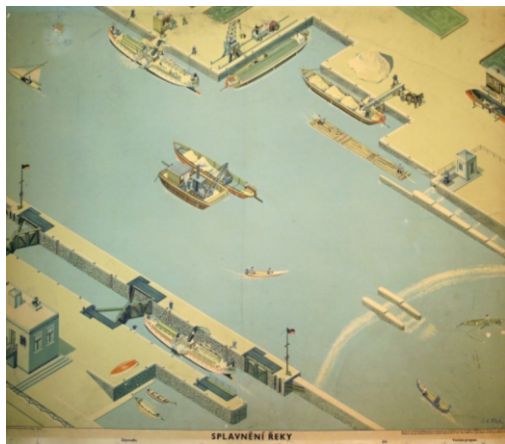
Školní obraz zachycující zdymadlo, vorovou propust a jez na řece. Daněš, G. – Vítěk, A: Splavnění řeky. Praha 1936.
