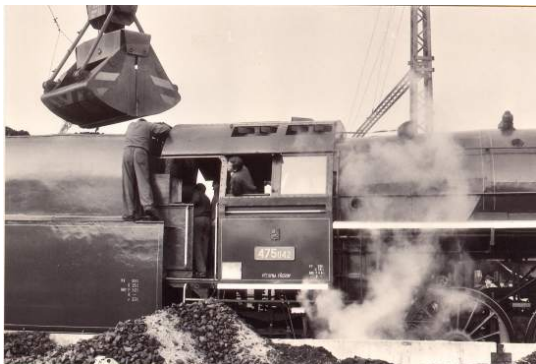
Zbrojení lokomotivy 475.1 uhlím v přerovské výtopně
