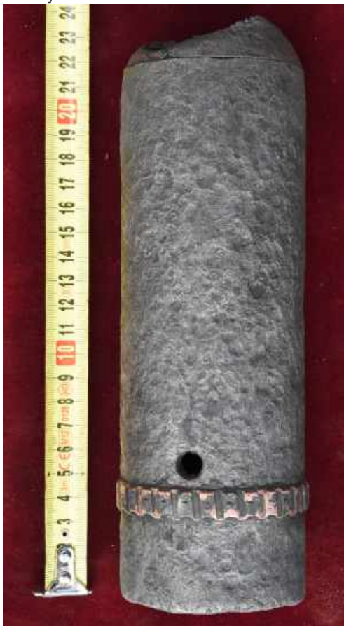
Delaborovaný dělostřelecký šrapnel ráže 75mm s měděným vodícím proužkem.
