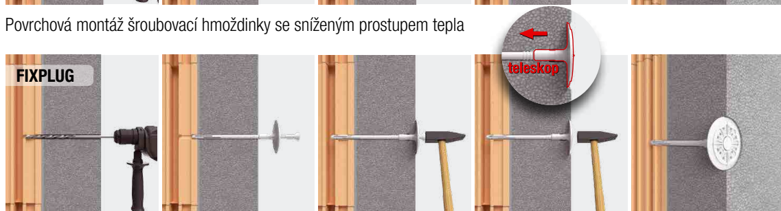
Povrchová montáž zatlukací hmoždinky s rektifikovatelným talířem a nulovým prostupem tepla
