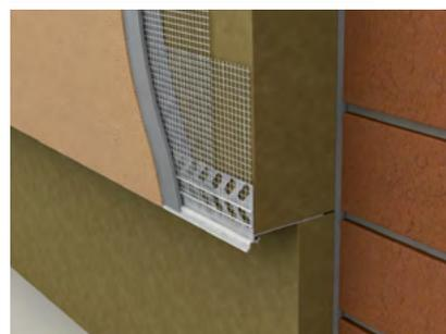
**LW-66-2 profilé de finition** avec goutte d'eau invisible et treillis d'armature en fibre de verre pour la finition du enduit et pour l'égouttement de l'eau entre deux panneaux isolants d'épaisseurs différentes dans un système ITE.
