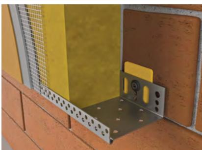
**LO perfor rail de départ perforé** avec goutte d'eau et perforations pour la pose et l'alignement des plaques d'isolant du système ITE.
