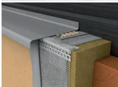
**LX-LPE profilé d'appui de fenêtre** et treillis d'armature pour finition de l'enduit et pour assurer l'évacuation de l'eau du linteau dans le système d'isolation thermique ITE.
