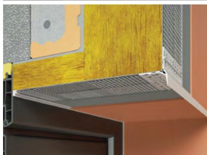
**VLTU profilé goutte d'eau apparent** et treillis d'armature pour finition de l'enduit et pour assurer l'évacuation de l'eau du linteau dans le système d'isolation thermique ITE.
