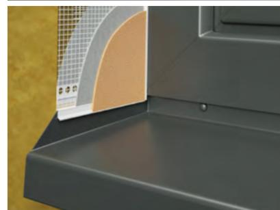
**LX-H profilé de liaison ajustable** avec goutte d'eau non-apparente (sous l'enduit), Treillis d'armature en fibres de verre et bande en mousse assurant la dilatation au niveau du raccord entre l'enduit et l'oreille de l'appui de fenêtre et permettant l'écoulement de l'eau du système ITE.
