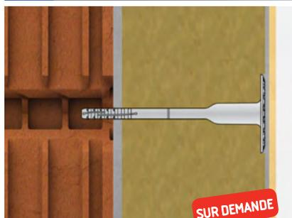
**R-TFIX-S 8 cheville avec vis métallique** pour la fixation des plaques d'isolant dans le système ITE
