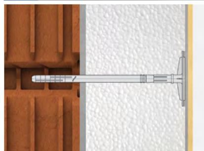
**FIXPLUG 8 cheville avec clou plastique** pour la fixation des plaques d'isolant thermique dans le système ITE.
