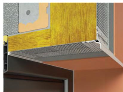
**VLTU-2H profilé goutte d'eau apparent** et treillis d'armature pour finition de l'enduit et pour assurer l'évacuation de l'eau du linteau dans le système d'isolation thermique ITE.
