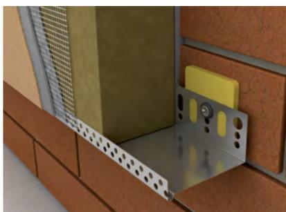
**LO rail de départ** avec goutte d'eau pour la pose et l'alignement des plaques d'isolants du système ITE.
