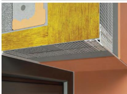
**LTDU profilé goutte d'eau non-apparente** (sous l'enduit) et avec treillis d'armature pour finition de l'enduit et pour assurer l'évacuation de l'eau du linteau dans le système ITE.
