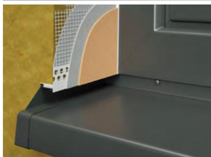
**LX-SPP profilé de liaison** avec goutte d'eau non-apparente (sous l'enduit), Treillis d'armature en fibres de verre et bande en mousse assurant la dilatation au niveau du raccord entre l'enduit et l'oreille de l'appui de fenêtre et permettant l'écoulement de l'eau du système ITE.
