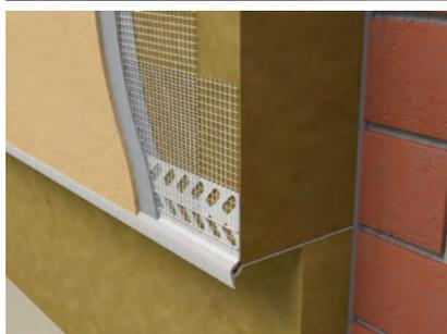
**LW-66 profilé de finition** avec goutte d'eau apparente et treillis d'armature en fibres de verre pour la finition de l'enduit et l'égouttement de l'eau entre deux panneaux d'isolant d'épaisseurs différentes dans système ITE.
