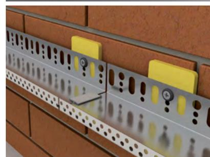
**Raccord des rails de départ** pour connexion des rails de départ du système d'isolation thermique ITE.
