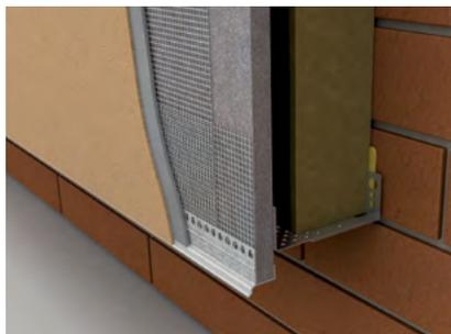
**LE-N profilé de finition avec goutte d'eau** pour panneaux de façades de systèmes ventilés.
