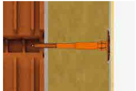
Tellerdübel PTH-EX 8 mit Metalldorn zur Befestigung der Wärmedämmplatten im WDVS
