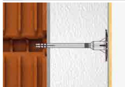
Tellerdübel KOELNER TFIX-P 8 mit vormontiertem Kunststoffdorn zur Befestigung von Wärmedämmplatten im WDVS
