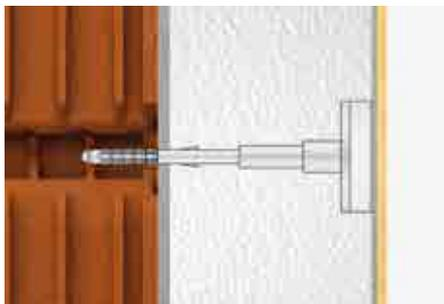
Tellerdübel eco-drive 8 mit vormontierter Metallschraube zur versenkten Montage von Wärmedämmplatten im WDVS
