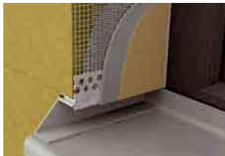
**LX-SPP Fensterbank-Anschlussprofil** mit nicht zuerkannter Unterputz-Tropfkante, Glasfaser-Armierungsgewebe und Schaumband zur Dehnungsfugenverbindung vom Putz ans Fensterbankendstück und zur Wasserableitung von der Wandbekleidung im WDVS.
