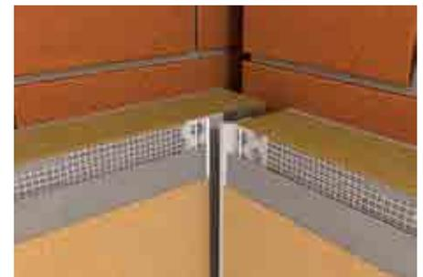
**LD-TOP Winkelprofil 2D** mit zuerkannter (sichtbarer) Kante und Glasfaser-Armierungsgewebe zum Anschluss einzelner Flächen mit sichtbarer Dehnfuge im WDVS
