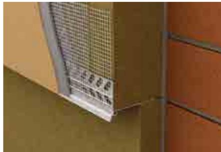
**Sockelkantenprofil LW-66-2** mit oben unsichtbarer Kante und Glasfaser-Armierungsgewebe für einen sauberen Putzabschluss und die Sicherstellung der Wasserableitung in der Übergangsstelle verschiedener Dämmstoffdicken im WDVS.
