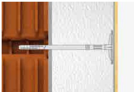
Tellerdübel **FIXPLUG 8** mit vormontiertem Kunststoffdorn zur Befestigung von Wärmedämmplatten im WDVS
