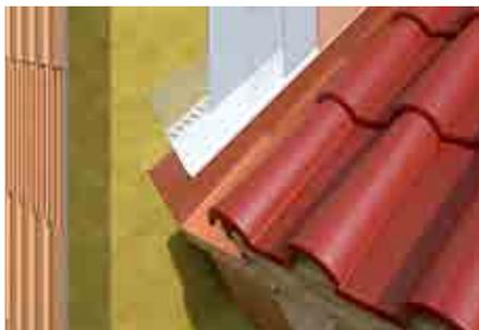
**LX-45 Blechanschlussprofil** mit Glasfaser-Armierungsgewebe zur Dehnungsfugenverbindung der Spengler-Elemente mit Putz in der Anschlussstelle an Blechverkleidung im WDVS
