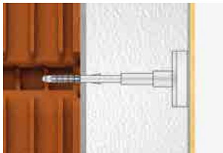
Tellerdübel eco-drive 8S mit vormontierter Metallschraube und vormontiertem EPS-Stopfen zur versenkten Montage von Wärmedämmplatten im WDVS
