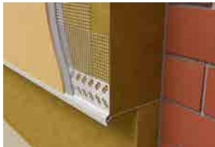
**Sockelkantenprofil LW-66** mit sichtbarer Kante und Glasfaser-Armierungsgewebe für einen sauberen Putzabschluss und die Sicherstellung der Wasserableitung in der Übergangsstelle verschiedener Dämmstoffdicken im WDVS.
