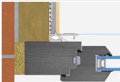
**LS2-FLEX 09 2D profilo per la spalletta della finestra** con membrana protettiva e rete in fibra di vetro per un collegamento flessibile del telaio della finestra o della porta agli intonaci nel sistema d'isolamento termico
