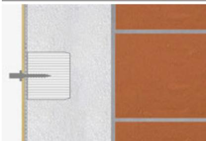
**Eco-Fix MZ Cilindro di montaggio** per il fissaggio di oggetti leggeri sul sistema d'isolamento termico
