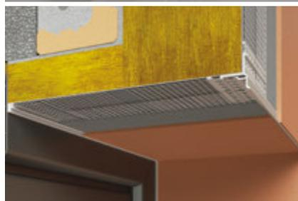
**LTU profilo rompigoccia per finestre** con gocciolatoio invisibile (nascosto sotto intonaco) e rete in fibra di vetro per la finitura di intonaci e il drenaggio dell'acqua nella parte superiore delle finestre nel sistema d'isolamento termico. Il profilo può essere usato anche come **profilo rompigoccia per balconi**. Il profilo può anche trovarsi nella parte inferiore del sistema quando non si utilizza il profilo di partenza LO per il contenimento alla base del materiale isolante.
