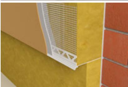
**LW-206 Profilo di transizione e finitura** con gocciolatoio invisibile e rete in fibra di vetro per la finitura precisa degli intonaci e per assicurare il drenaggio dell'acqua nei cambi di spessore dell'isolante nei sistemi a cappotto. In combinazione con il profilo LW-L forma il kit di partenza per i pannelli termoisolanti nei sistemi a cappotto.
