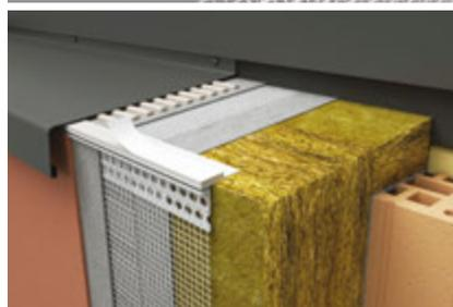
**LX-LPE FLEX profilo sotto-davanzale** con angolo variabile e rete in fibra di vetro e nastro in polietilene per assicurare una connessione elastica del davanzale della finestra al sistema d'isolamento termico
