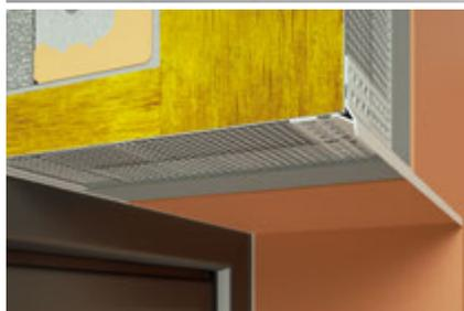
**VLT LITE profilo rompigoia per finestre** con gocciolatoio a vista e rete in fibra di vetro incollata alle ali del profilo per la finitura di intonaci e il drenaggio dell'acqua nella parte superiore delle finestre nel sistema d'isolamento termico. Il profilo può essere usato anche come profilo rompigoia per balconi. Il profilo può anche trovarsi nella parte inferiore del sistema quando non si utilizza il profilo di partenza LO per il contenimento alla base del materiale isolante.
