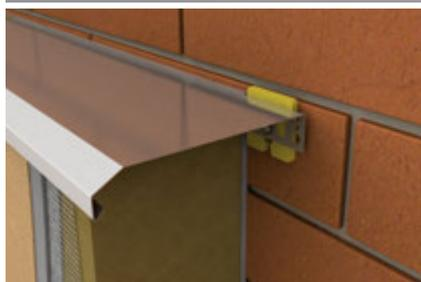
**LU-Z profilo di chiusura** con gocciolatoio viene utilizzato nella parte superiore del sistema d'isolamento per chiuderlo ed impedire la penetrazione dell'acqua. Questo profilo è destinato all'uso nei dettagli in cui la connessione al muro deve essere protetta dall'acqua piovana.
