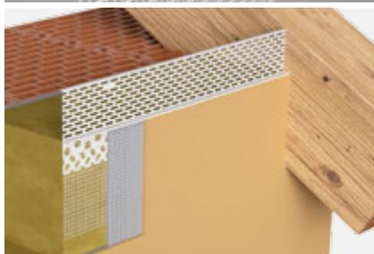
**LX-DB profilo di chiusura per ventilazione** per la finitura dell'intonaco nei sistemi con intercapedine di ventilazione nella chiusura del tetto
