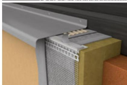
**LX-LPE profilo sotto-davanzale** con rete in fibra di vetro e nastro in polietilene per assicurare una connessione elastica del davanzale della finestra al sistema d'isolamento termico
