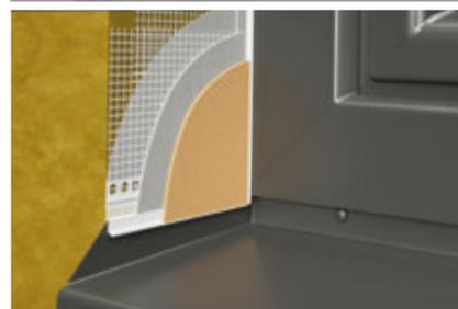
**LX-H profilo di collegamento flessibile** con rete per davanzali con gocciolatoio nascosto per creare giunzioni flessibili tra intonaco e fine davanzale nel sistema d'isolamento termico
