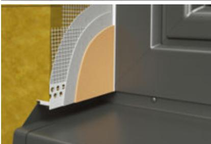
**LX-SPP profilo di collegamento per davanzali** con rete in fibra di vetro e nastro in polietilene per assicurare una connessione elastica dell'intonaco alla fine della soglia e per drenare l'acqua dalla spalletta nel sistema d'isolamento termico
