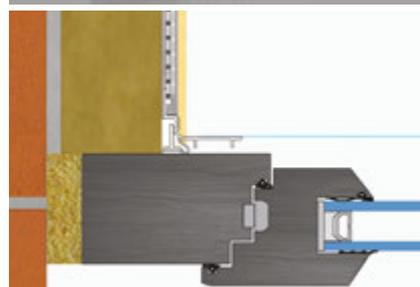
**LS3-400 3D profilo per la spalletta della finestra** con rete in fibra di vetro per un collegamento flessibile in 3 direzioni tra il telaio della porta o della finestra e l'intonaco nel sistema d'isolamento termico
