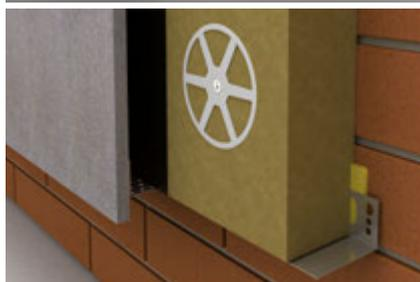
**TDP 90 rondella di fissaggio supplementare** per ancoraggi ad avvitare e a martello per il fissaggio dei pannelli isolanti nel sistema di facciata ventilata
