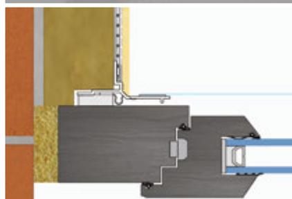
**LS3-200 3D profilo per la spalletta della finestra** con rete in fibra di vetro per un collegamento flessibile in 3 direzioni tra il telaio della porta o della finestra e l'intonaco nel sistema d'isolamento termico
