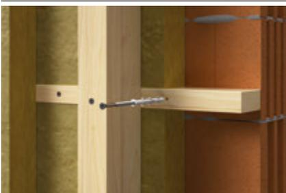
**KPS-FAST S tassello ad avvitare** per il fissaggio di telai in legno nelle facciate ventilate
