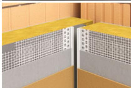
**LD-NH profilo di dilatazione angolare** con rete in fibra di vetro per il collegamento su facciate ad angolo con giunti di dilatazione a vista nel sistema d'isolamento termico a cappotto
