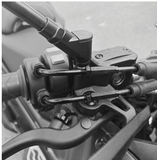
Nastavenie vôle ovládania plynu.
