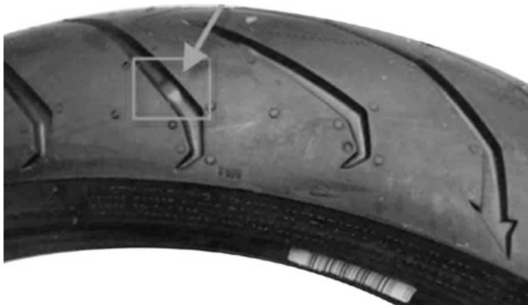
Indikátor opotrebovania TWI v behúni pneumatiky.
