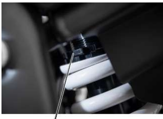
Nastavovací kroužek předpětí pružiny zadního tlumiče
