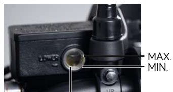
Přední nádržka brzdové kapalin (pravá strana, na řídicích)
