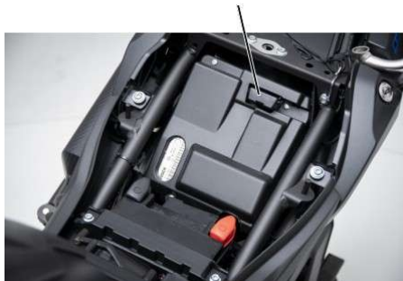
Diagnostická zásuvka (pod krytkou)
