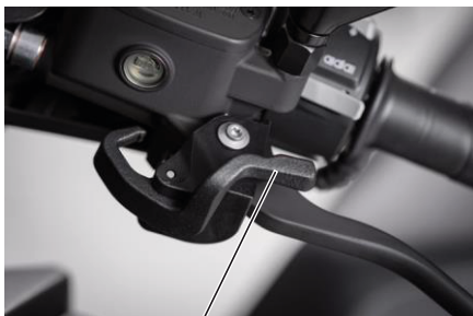
Odjištěná páka parkovací brzdy
