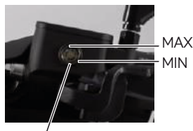
Kontrolní okénko brzdové pumpy zadní brzdy
