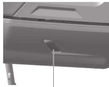
Kontrolní okno expanzní nádoby (na pravé straně)
