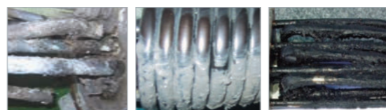
Škody na topné spirále způsobené vodním kamenem
