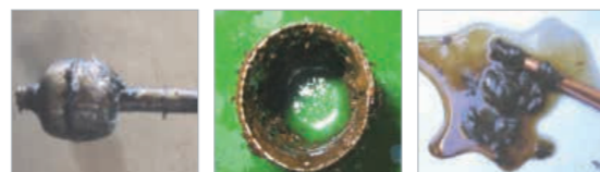
Závada způsobená nečistotou
